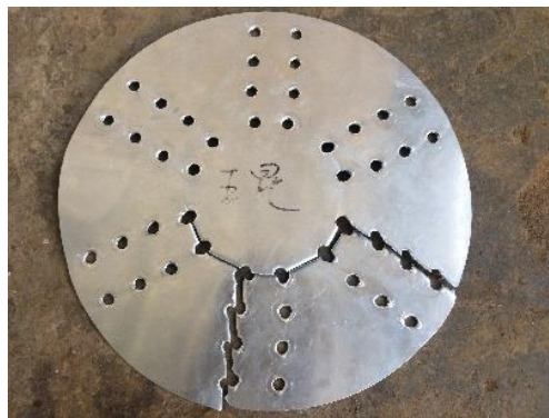
节点板 块状拉剪破坏
